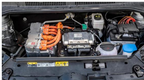
3. ábra: Elektromos autó nagyfeszültségű rendszerének elemei narancsszínűek (forrás: http://totalcar.hu/ )
