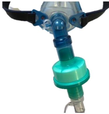
3. ábra: A légzőkör összeállítása HME-filterrel, kapnográfal
