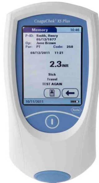
129. ábra: Protrombin időt mérő POCT készülék (forrás: Internet)
