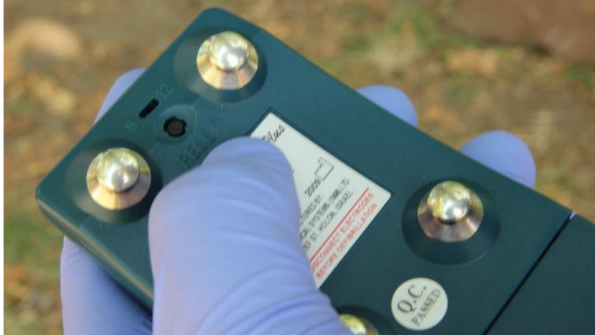
118. ábra: A készülék hátlapján négy fémlábacska látható, ezek érintkeznek a mellkas bőrével.
