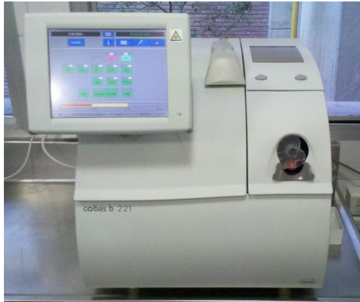
127. ábra: Vérgázanalizátor POCT készülék (forrás: Internet)
