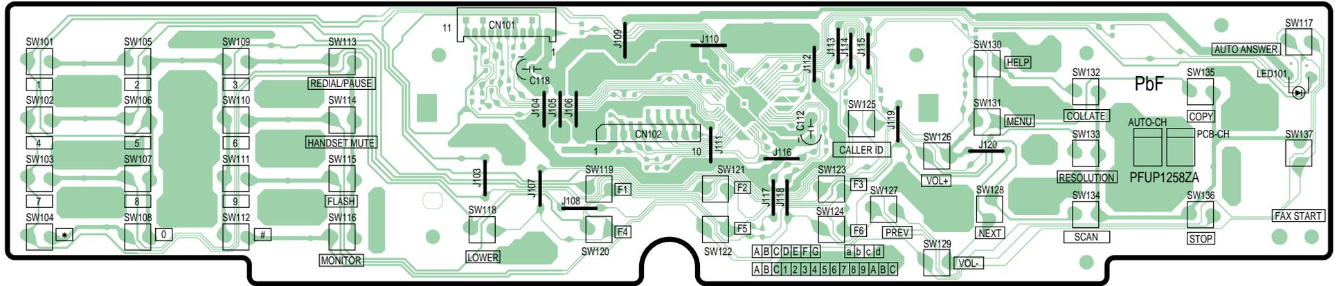
KX-FLB758EX OPERATION BOARD (PCB3) COMPONENT VIEW
