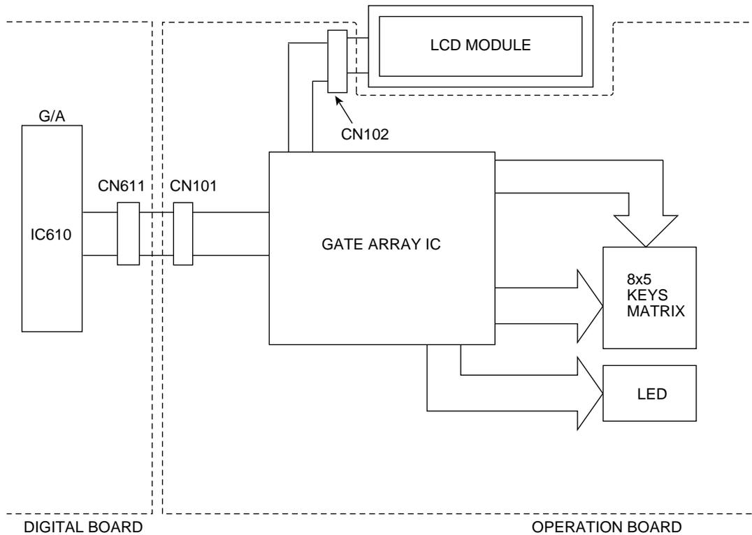
KX-FLB758PD : OPERATION BOARD : BLOCK DIAGRAM
