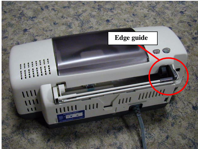
Figure 4-2. Position of Edge guide
